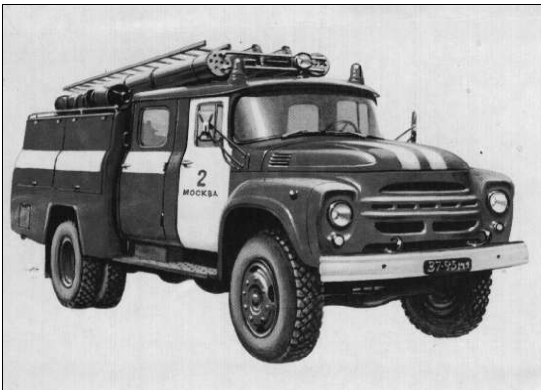
Автоцистерна АЦ-40 (130), Модель 63 Б (1970 г.)
